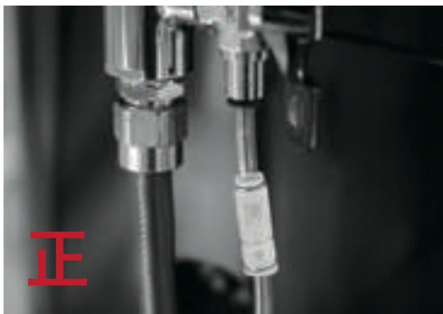
6ミリチューブは全てチューブフィッティングという形式で接続されています。
